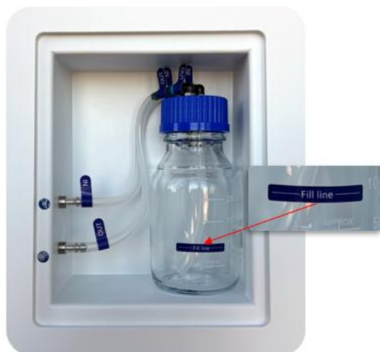
Figure 21.1 Raccordement du tube sur la bouteille d'humidification et le poste de travail ART multizone
